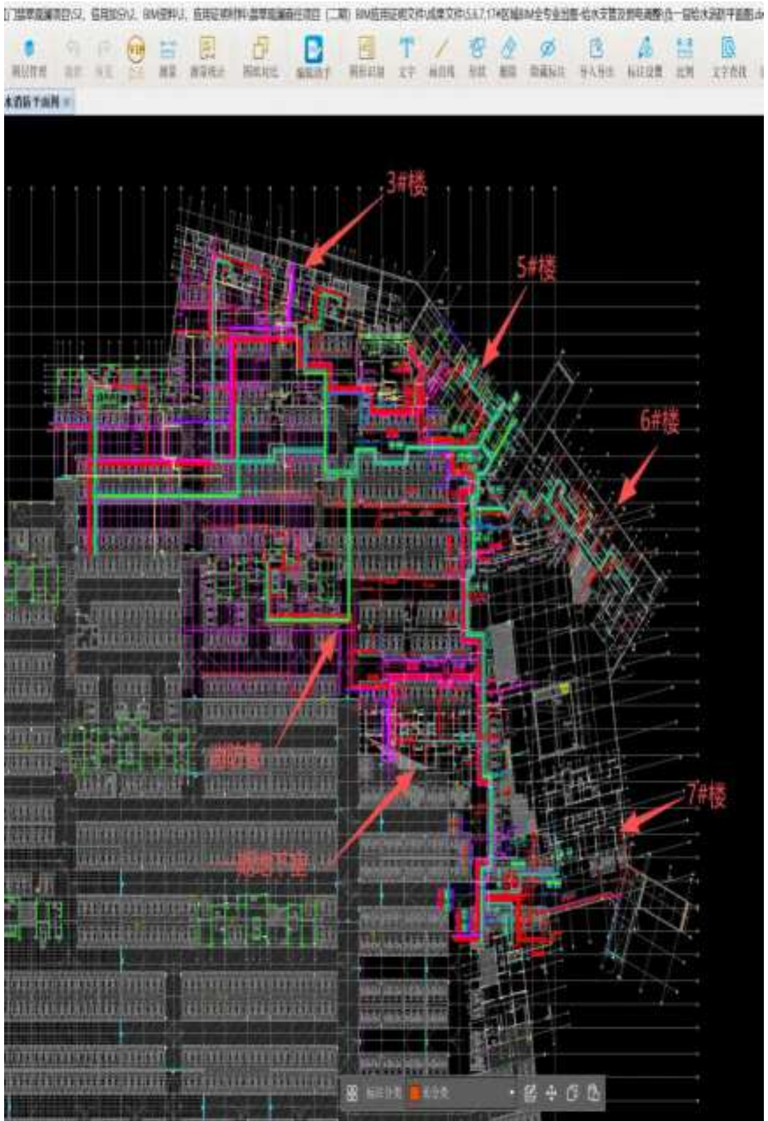
《翡翠观澜项目一期地下室（5,6,7,17#区域）BIM给水支管及弱电调整图》
