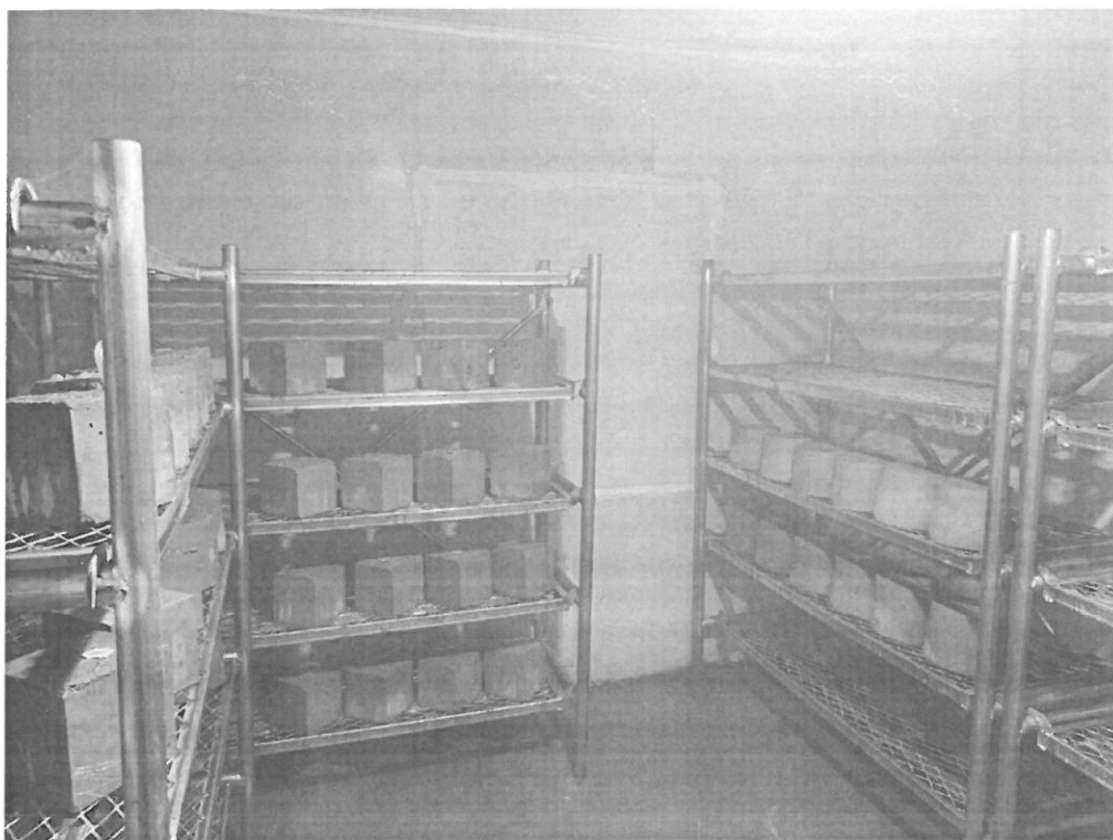
养护室试块摆放
