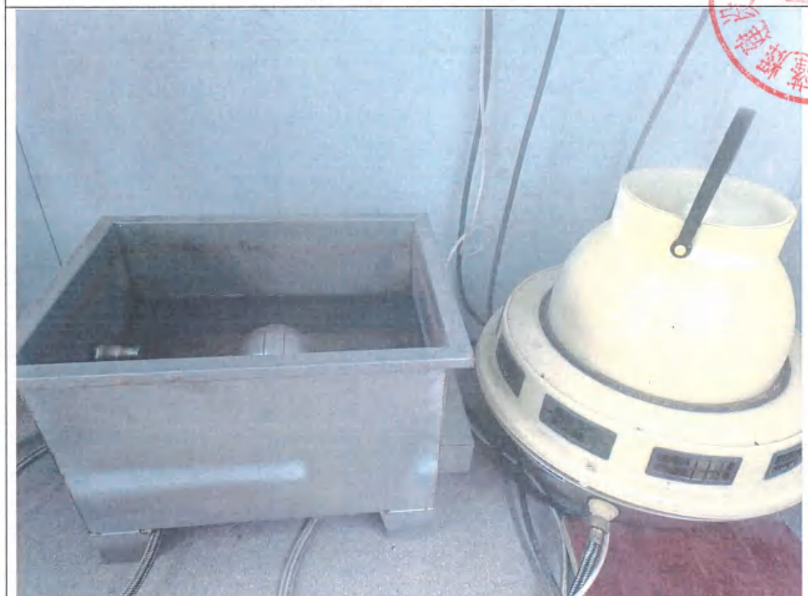
养护室加湿器
